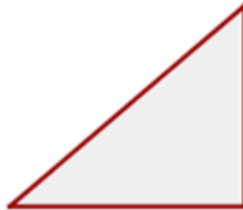
Un ángulo recto El lado mayor es la hipotenusa. Los lados menores son los catetos.
